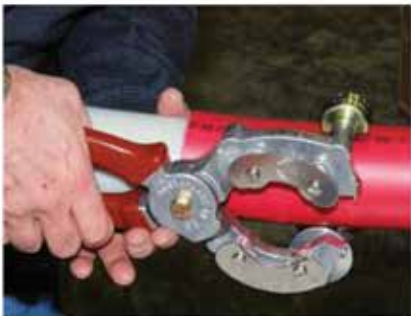
Longitudinal Jacket Cut
